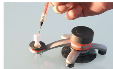
3. Becsavarozzuk az injektorhengert, és WRK kitöltőgyantával kitöltjük, ...
